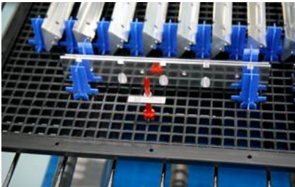
Broches : rotation, emboîtement, empilage
